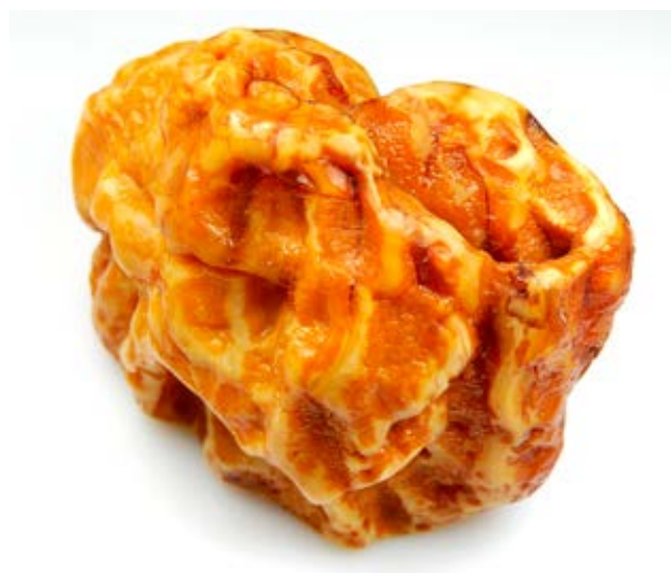
Bryła żywicy epoksydowej (675 g) badana w Laboratorium Bursztynu MSB Lump made of epoxy resin (675 g) tested in IAA Amber Laboratory
